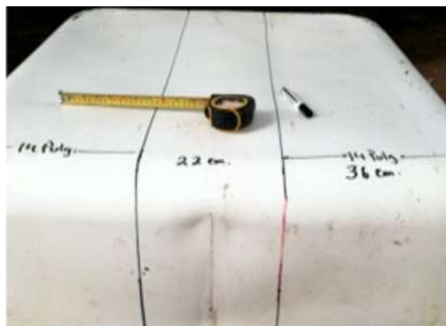
Trazado de los cortes en el centro del tanque para obtener dos contenedores para maceteras.
