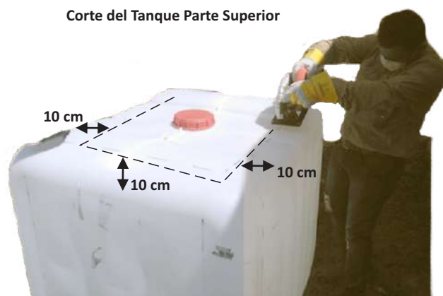
En el tanque IBC se traza en la parte superior la línea de corte para la pecera del sistema.
