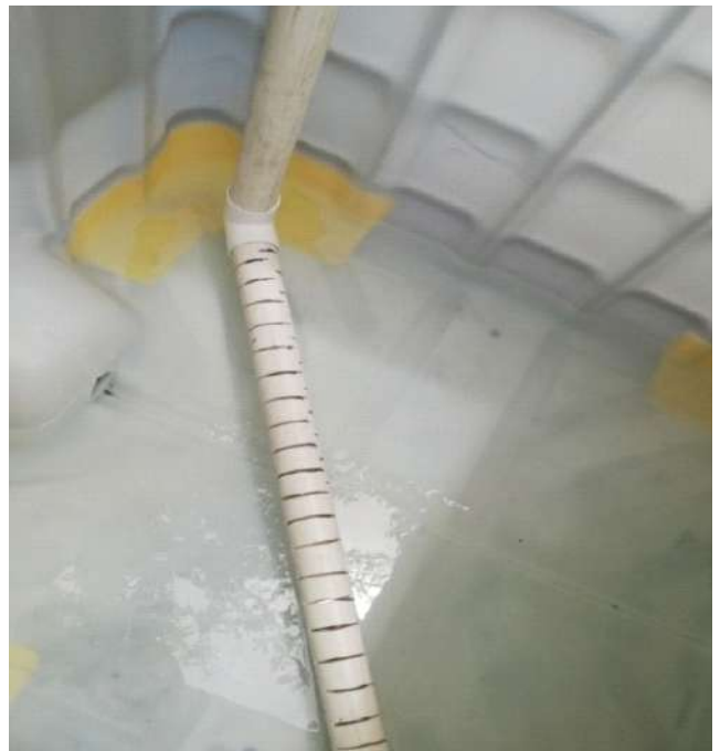
El filtro en forma de L, construido de tubería PVC, va colocado al fondo del tanque de peces.
