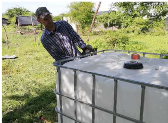
Se retiran las barras metálicas horizontales
