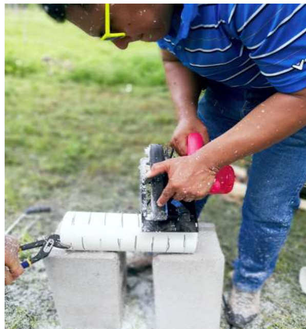
Preparación de las ranuras que lleva el protector de campana para que no filtre el sustrato por el sifón.
