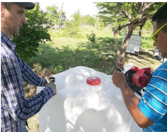
Sobre las líneas trazadas, se realiza el corte en el tanque para maceteras
