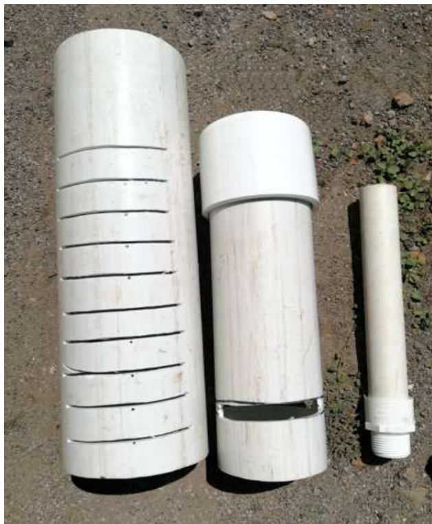
Las tres partes elaboradas de tubería PVC de que se compone el sifón de campana colocado en cada macetera de plantas.
