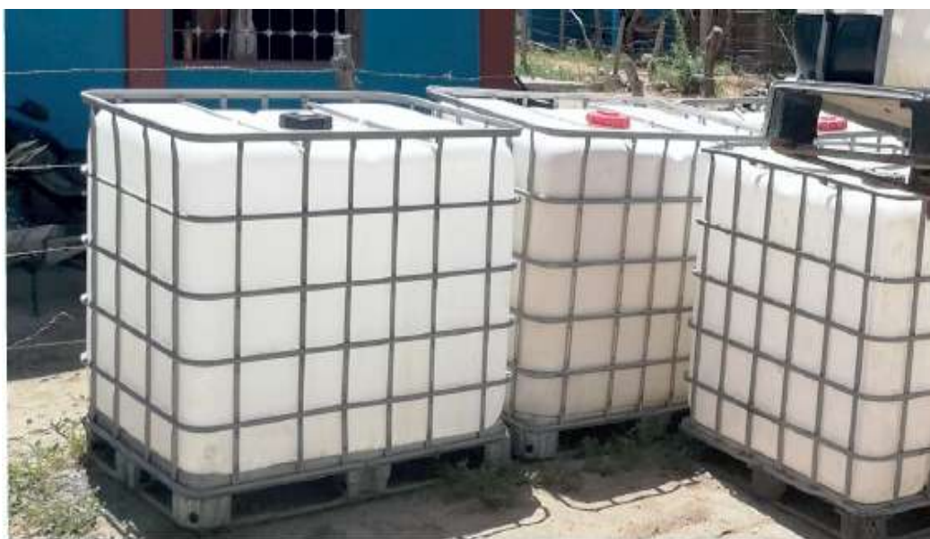
En la construcción de los depósitos para los componentes del sistema de acuaponía a escala baja, se requiere de tres tanques tipo IBC de 1000 litros.
