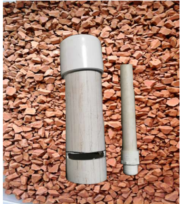
Tipo de sustratos y dispositivos de sifón de campana utilizado en la técnica de lecho de sustrato
