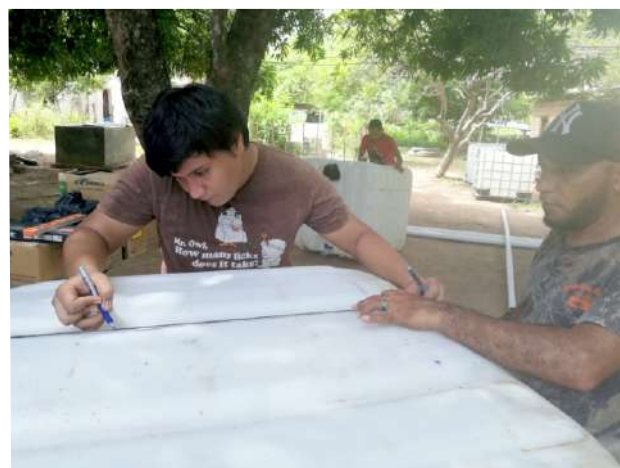
En el tanque IBC se traza en la parte superior la línea de corte para la pecera del sistema.
