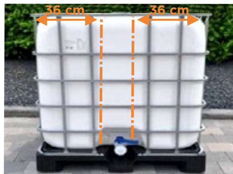
Trazo y corte de barras en la parte central de la estructura de metal para obtener dos soportes para igual cantidad de maceteras.
