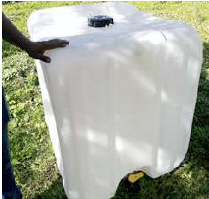
Posición del tanque para iniciar el trazado de corte de tapa superior del mismo.
