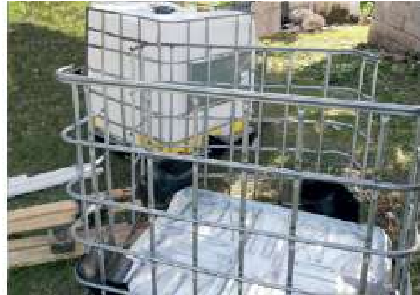
Se debe separar el soporte de metal, para luego trazar las medidas para el corte del tanque de peces
