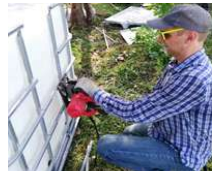
Trazo y corte de barras en la parte central de la estructura de metal para obtener dos soportes para igual cantidad de maceteras.
