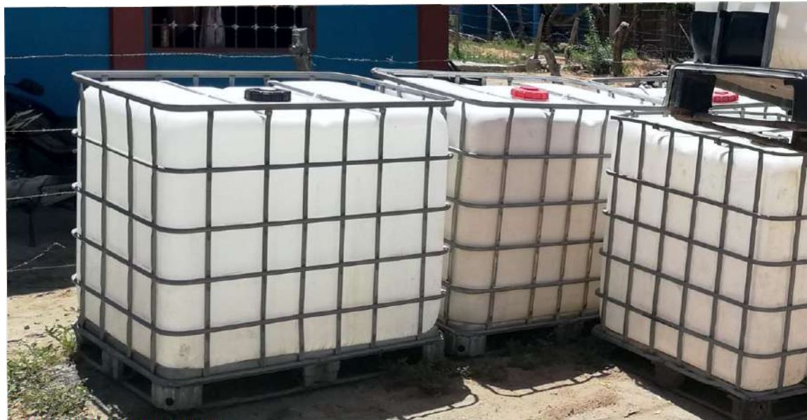
Tipo de tanques IBC para preparar los diferentes contenedores de que se compone el sistema de acuaponía.
