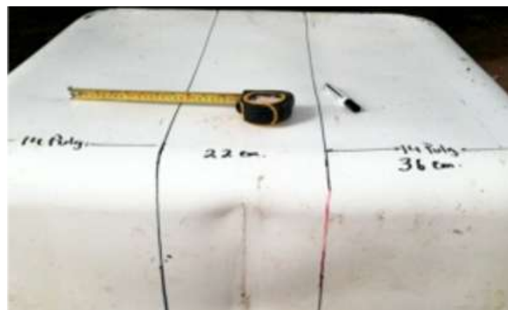
Líneas de corte sobre el tanque del cual se obtendrán dos depósitos para las maceteras de plantas.
