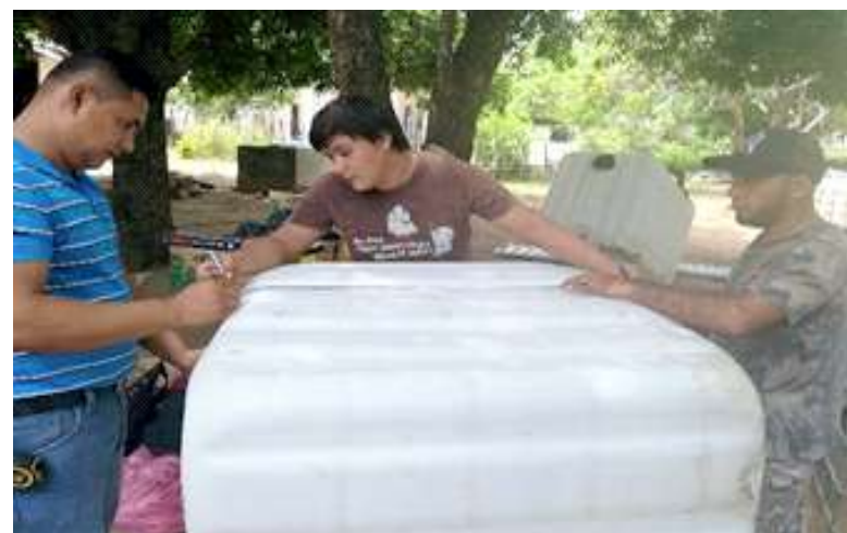
El trazado de línea de corte en la parte superior del tanque, sirve para extraer una tira y liberar la entrada de los peces y otras labores.
